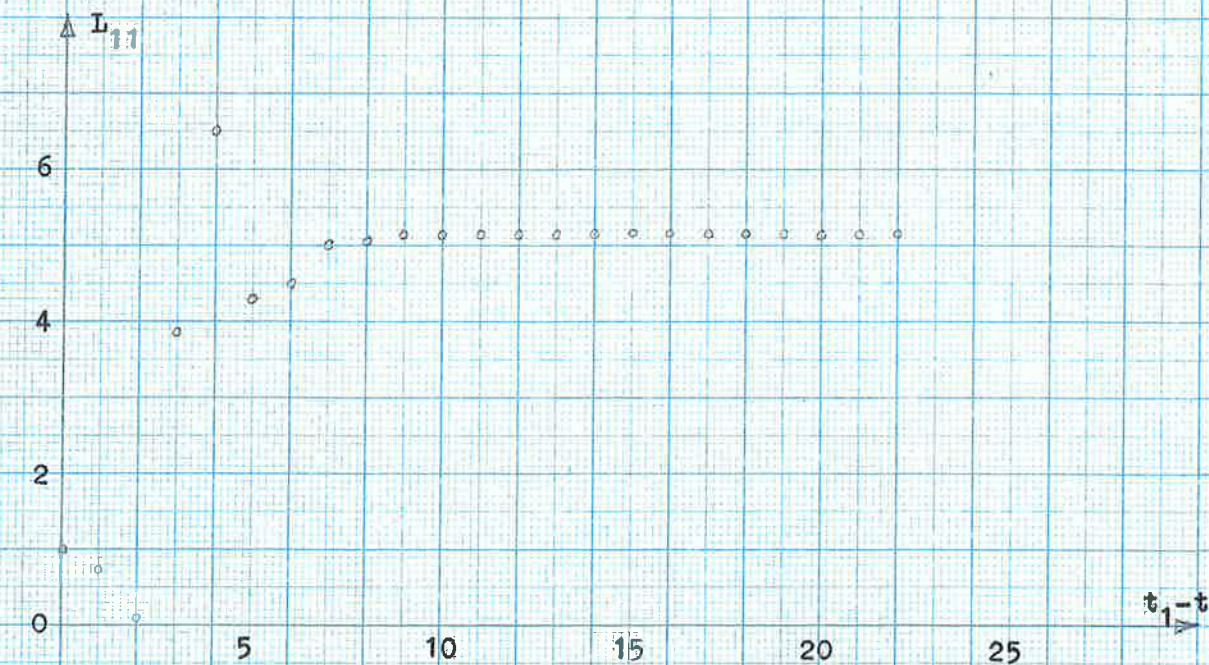
Figur 4a. Exempel på hur styrlagen konvergerar för system (B) med Q_0 = [0] .
