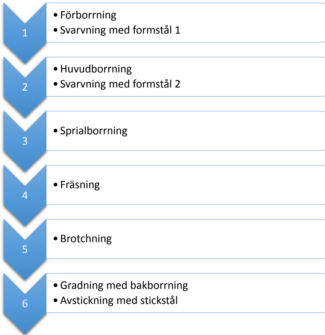
Figur 10 – Visar händelseförloppet i maskinen vid tillverkning av hylsan.
