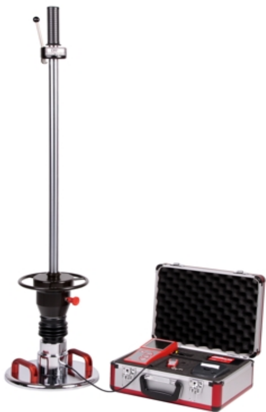
Figur 14: Lätt fallvikt av tyskt fabrikat (HMP Magdeburger Prüfgerätebau GmbH, u.å.).
