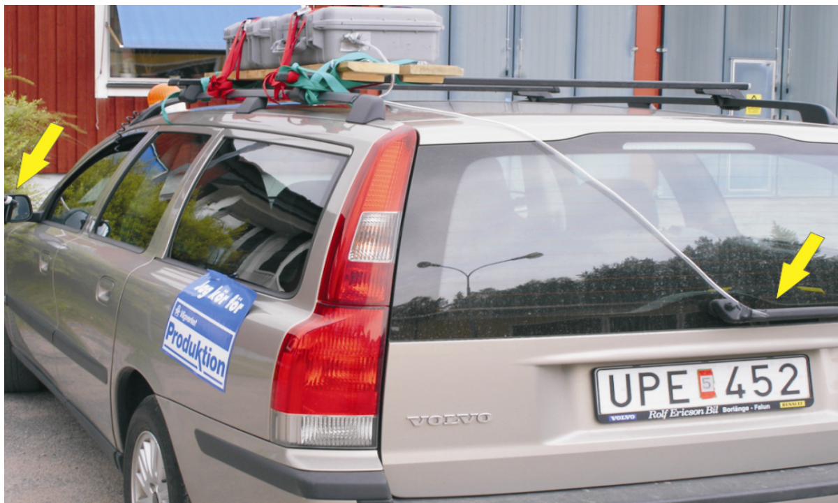
Figur 7: Bild på det fordon som var utrustat med TSI DustTrak-utrustning. Pilarna anger placeringen av partikelinsugen (Oscarsson, 2007a).
