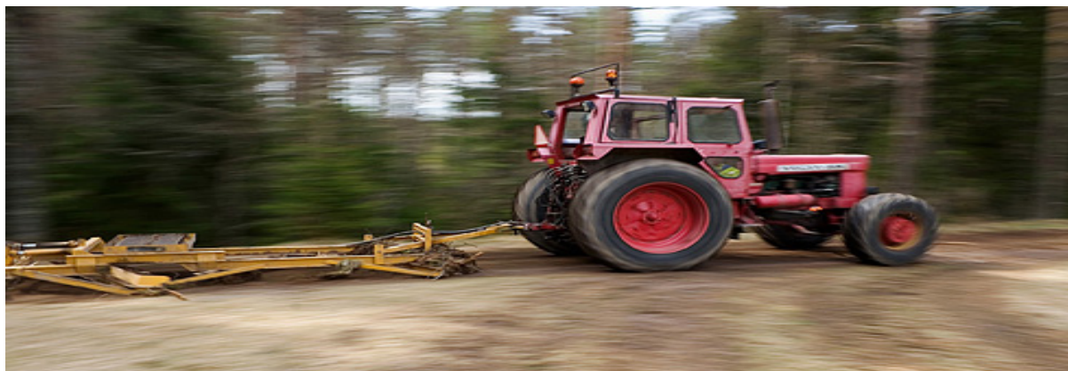
Figur 8: Traktordragen vägsladd (Kunskap Direkt, 2015d).
