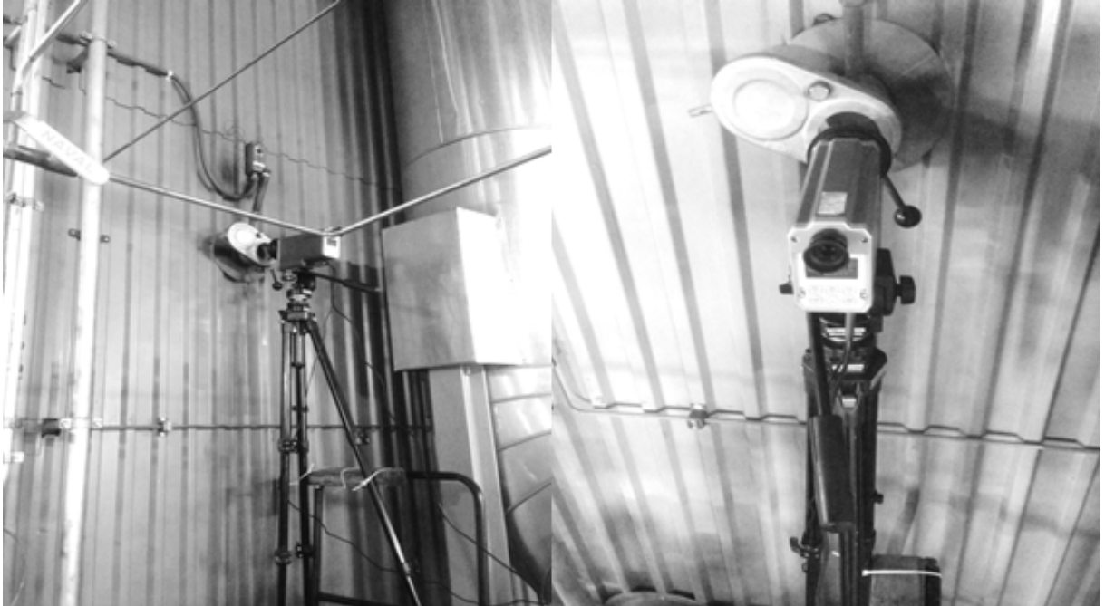
Figur 4.2. Försöksupställning för mätning med IR pyrometer genom synfönster på Panna 3.
