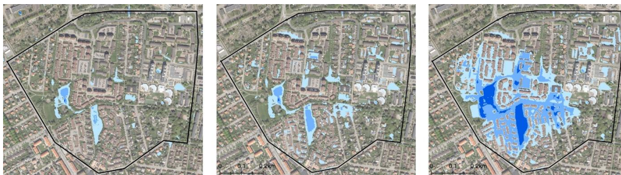
Figur 7.1 – Jämförelse mellan skyfallskartering i GIS (t.v.) i MIKE 21 med ledningsnät (mitten) och MIKE 21 utan ledningsnät (t.h.) © Lantmäteriet [I2014/00579].
