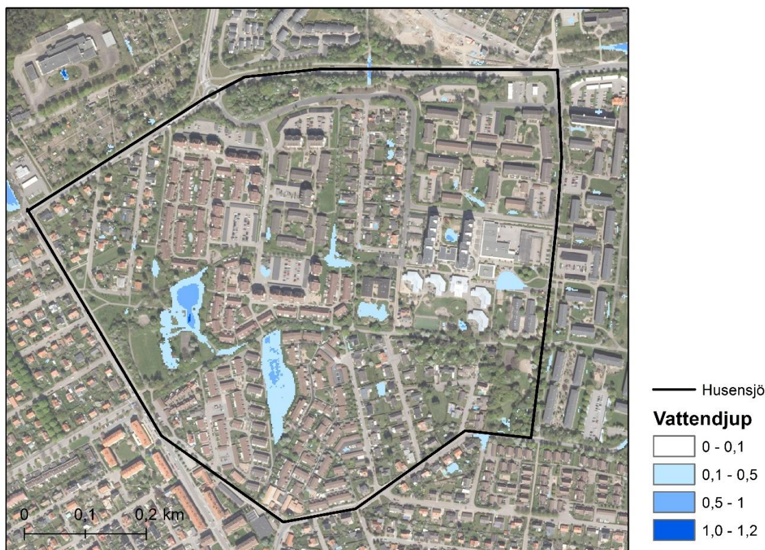
Figur 6.9 – Detaljkarta över Husensjö med vattendjup från GIS-karteringen baserat på topografien. © Lantmäteriet [I2014/00579].
