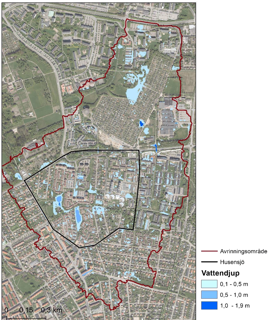
Figur 6.1 – Karta över avrinningsområdet med resulterande vattendjup vid ett skyfall motsvarande Malmöregnet 2014 med ledningsnätet inkluderat © Lantmäteriet [I2014/00579].
