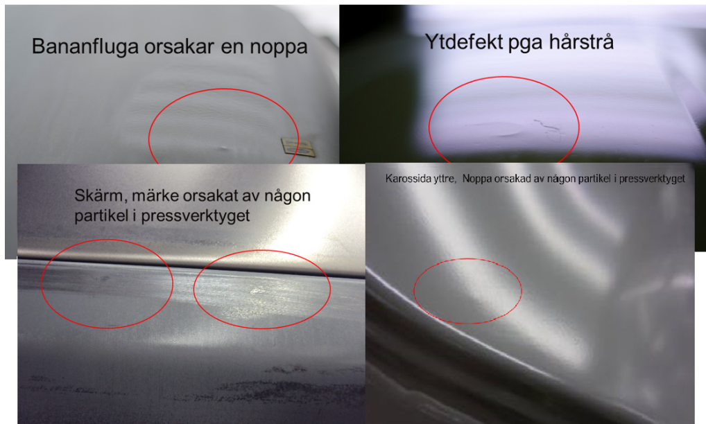
Figur 12 Bilden ovan visar hur några defekter kan se ut.
