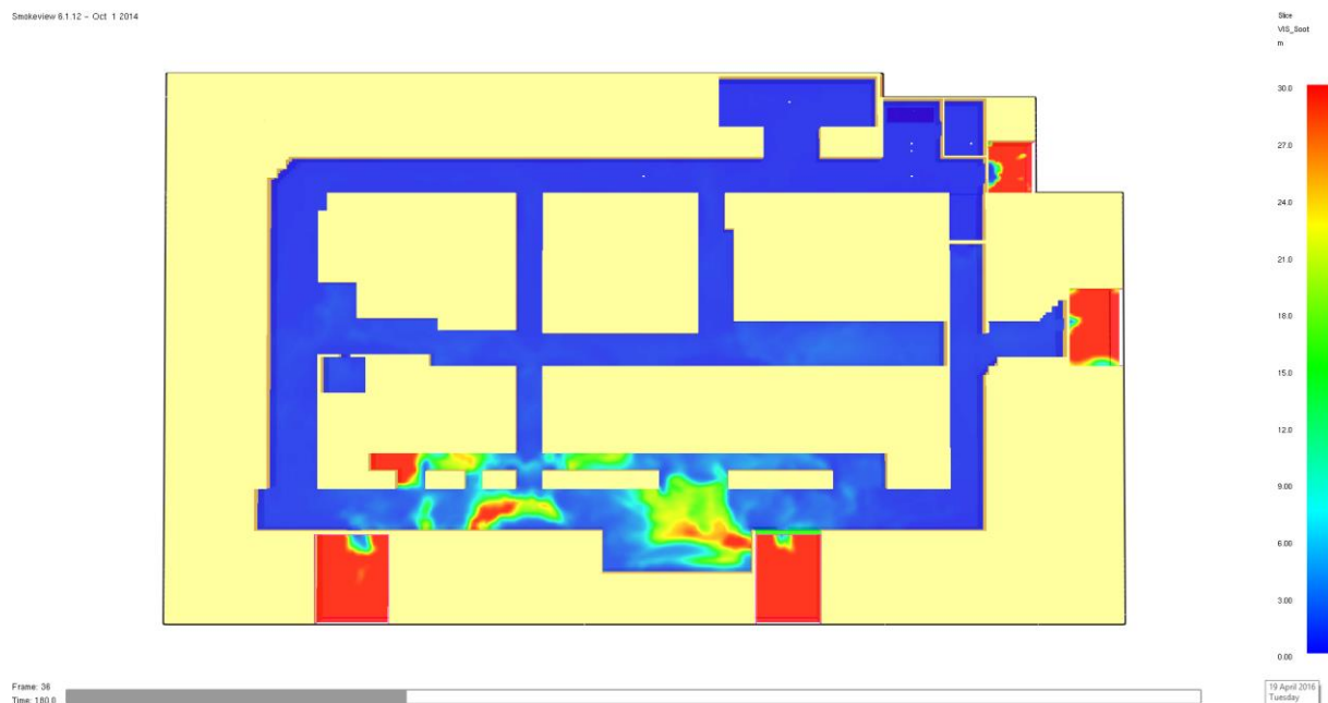
Figur 28. Slice file som visar sikten i fallet väntrum när två soffor brinner efter 180 sekunder in i brandförloppet.
