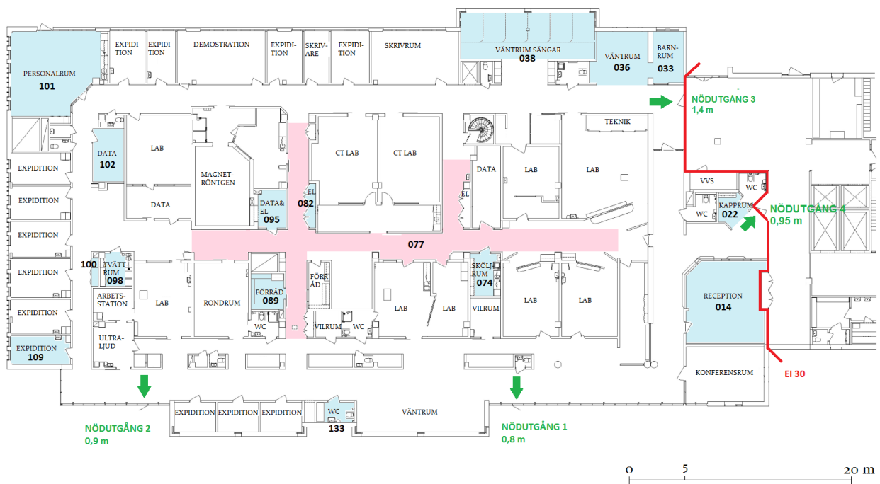
Figur 15. Översikt av var i byggnaden de olika scenariona utspelar sig. Den rosa ytan avser installationsgolvet som sträcker sig genom hela manöverkorridoren på avdelningen. De blå ytorna illustrerar placeringen av identifierade brandscenarier.
