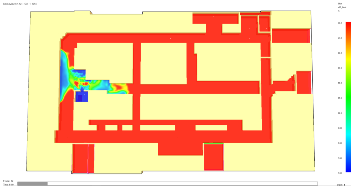
Figur 47. Slice file som visar sikten i fallet tvättrum med Fast tillväxt efter 60 sekunders brandförlopp.
