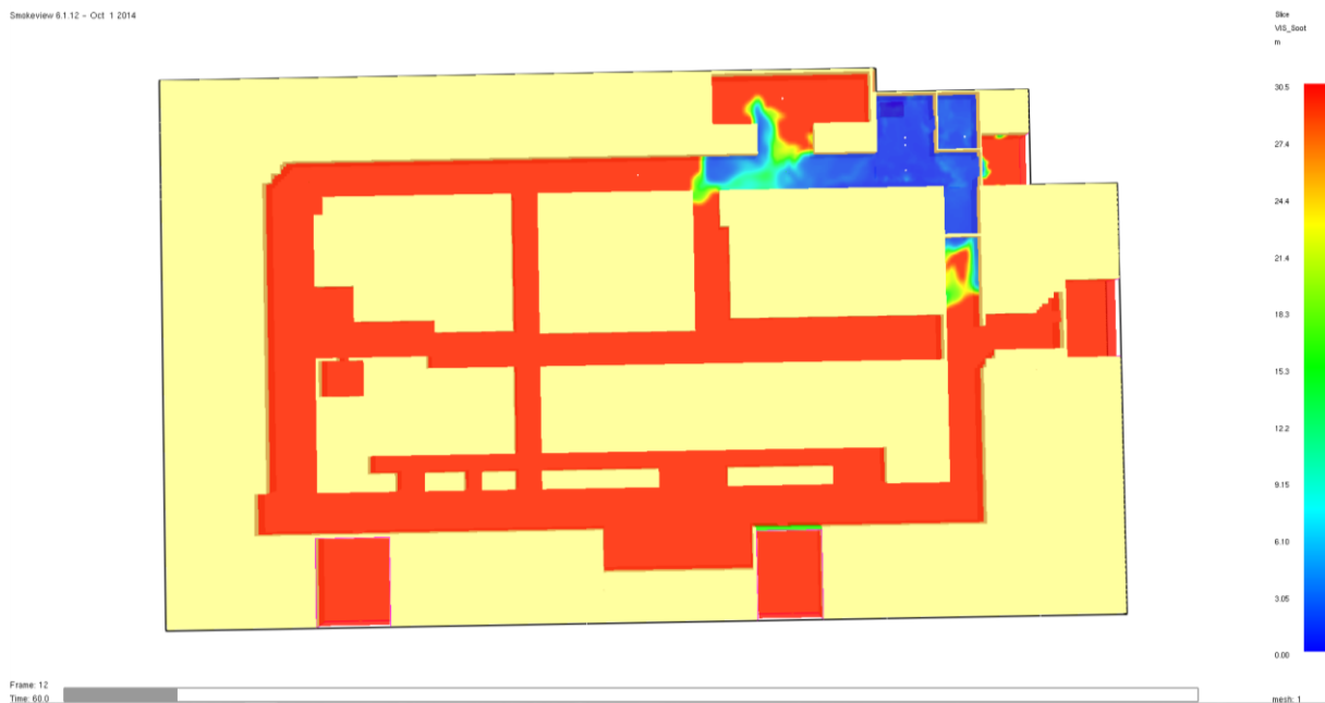
Figur 65. Slice file som visar sikten i scenario 2, brand i väntrum, efter 60 sekunders brandförlopp när sprinkler reducerar effektutvecklingen.
