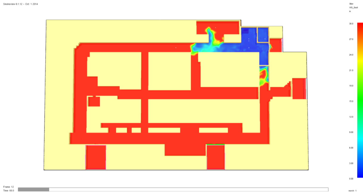
Figur 25. Slice file som visar sikten i fallet då brand uppstår i väntrummet och en soffa brinner efter 60 sekunders brandförlopp.
