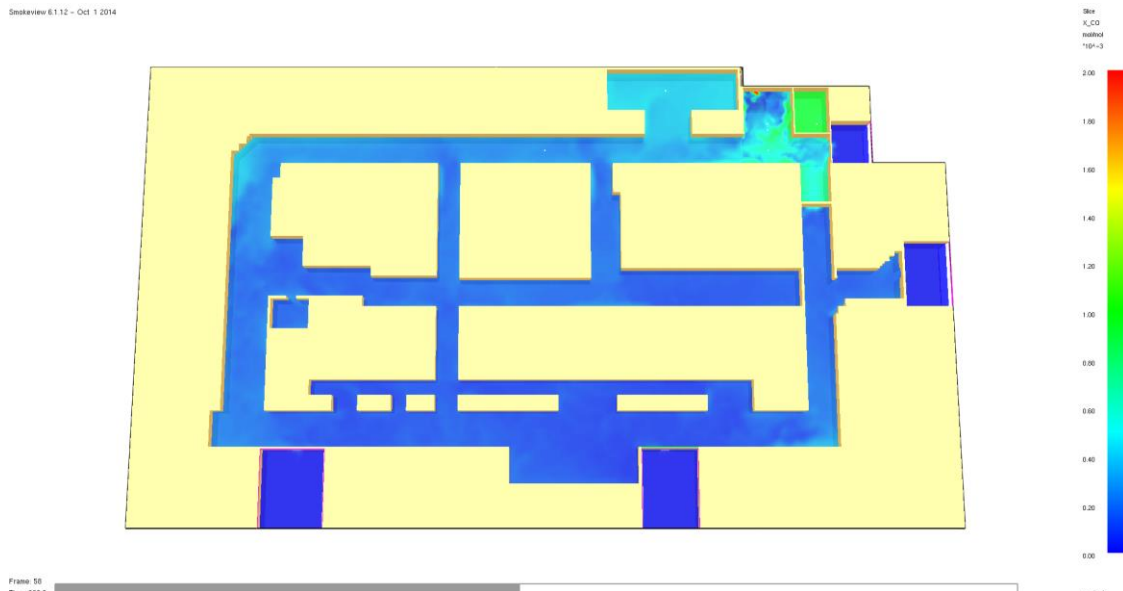
Figur 33. Slice file över kolmonoxidkoncentrationen i simuleringen för väntrummet när en soffa brinner.
