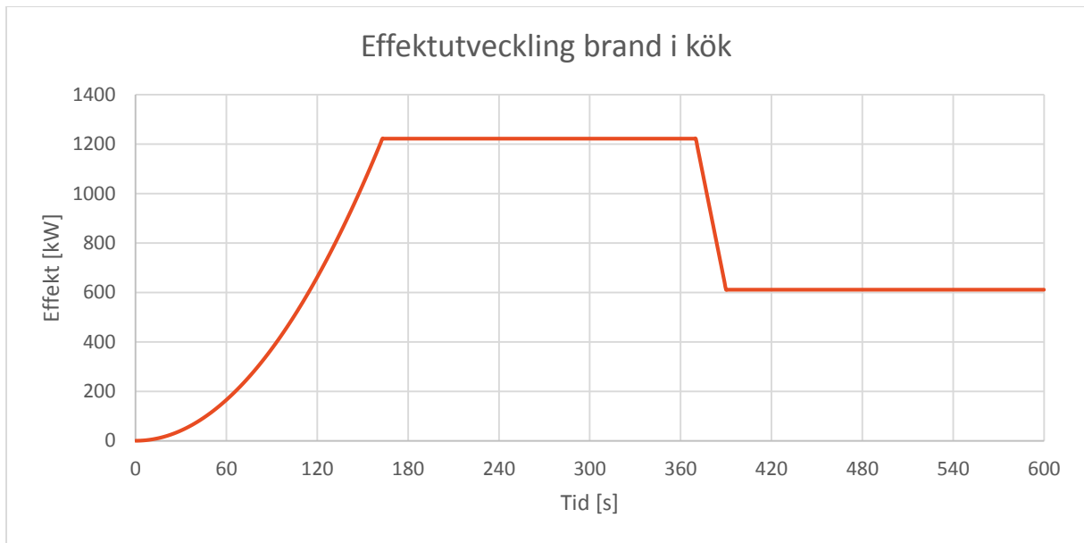
Figur B.3. Effektutveckling för köksbranden under brandförloppets inledande tio minuter.
