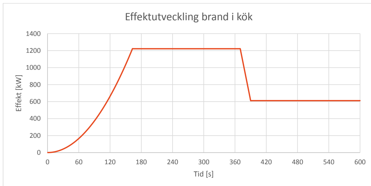
Figur 9.2. Effektutveckling för köksbranden under förloppets inledande tio minuter.
