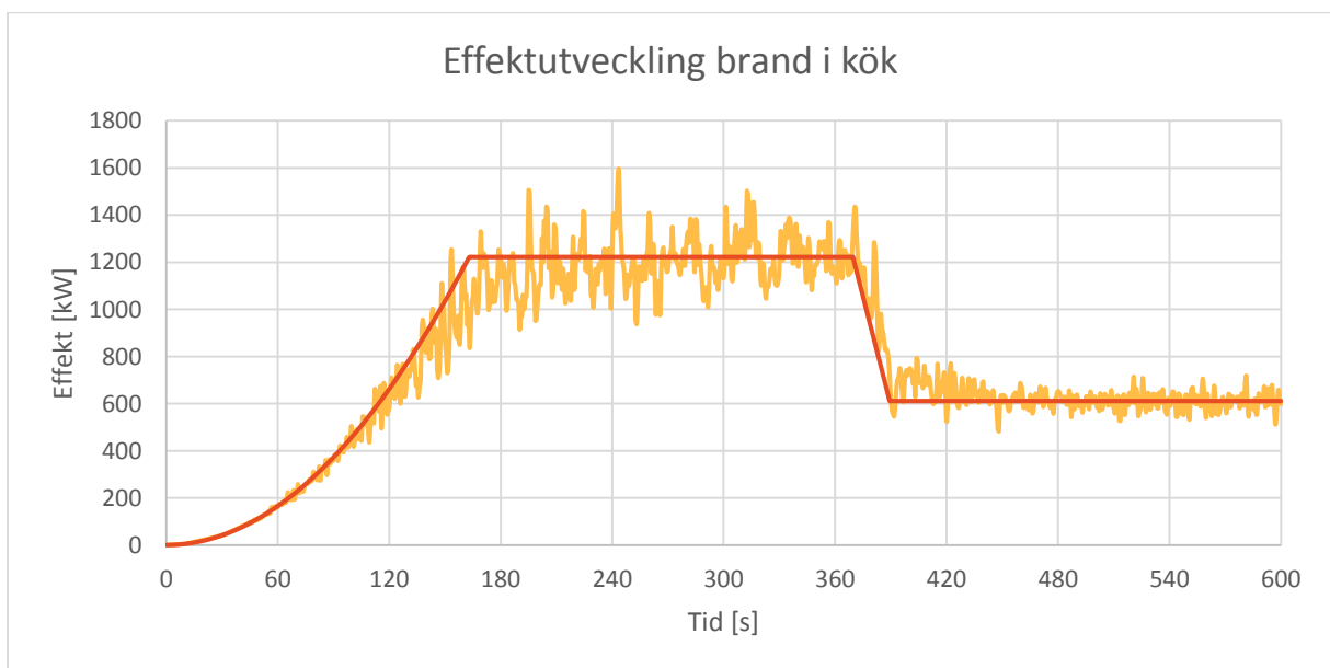
Figur C.6. Jämförelse av den teoretiskt framtagna (röd) och den av FDS genererade (gul) effektutvecklingskurvan för köket under tio minuter.
