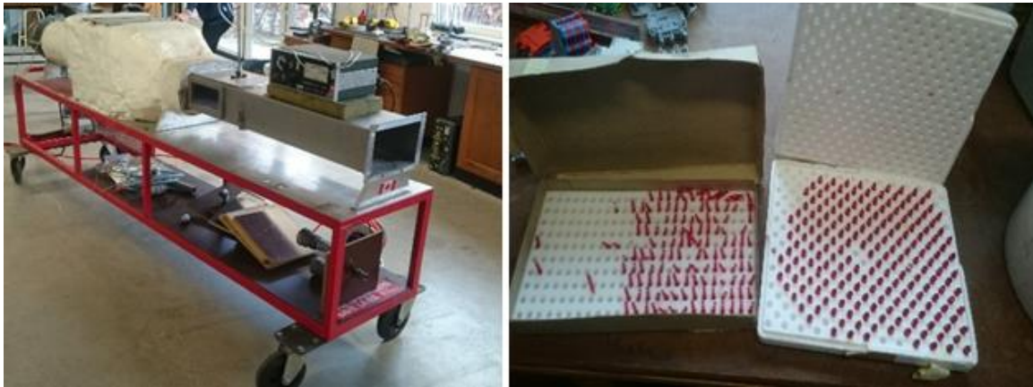
Figur 13. T.v visar vindtunnel som användes vid experimenten. T.h. Visar sprinklerbulber som användes vid experimentet.
