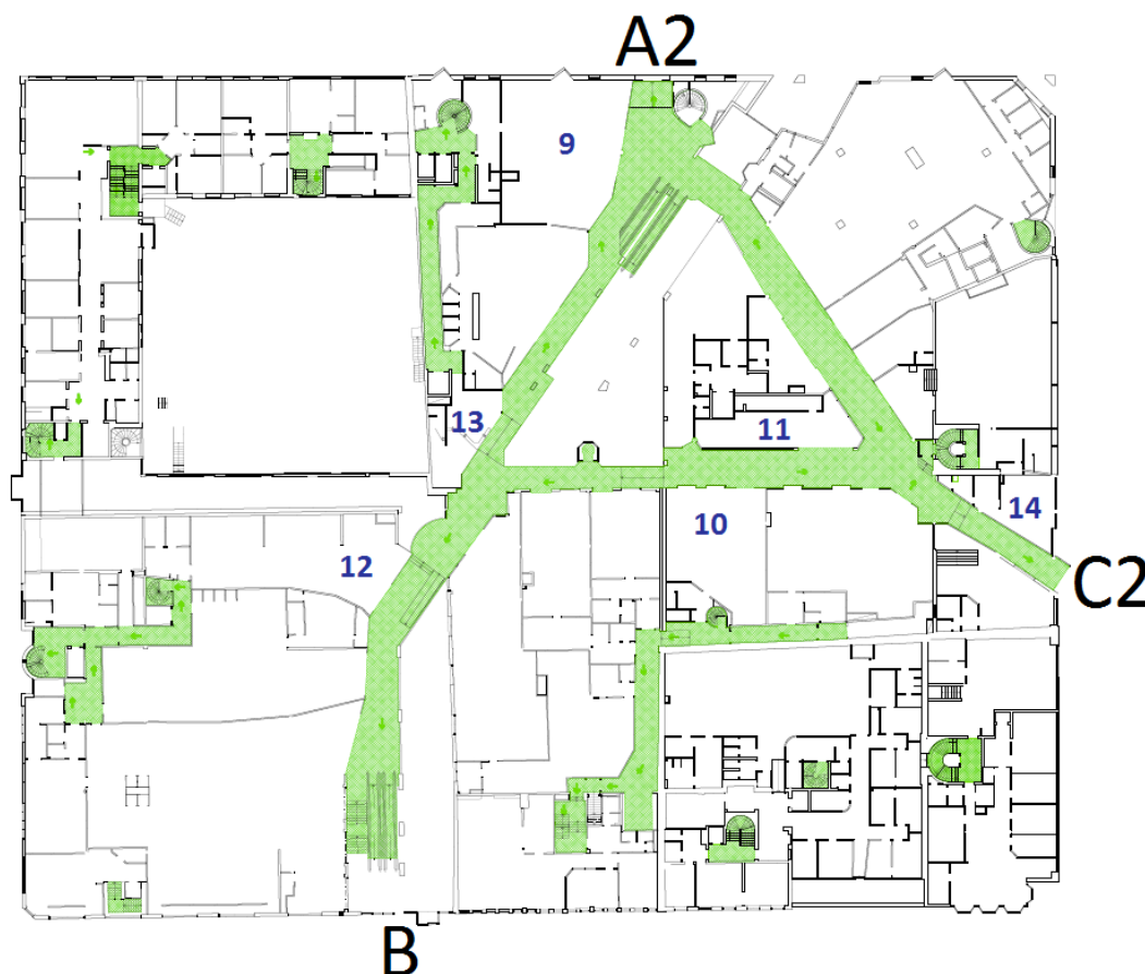
Figur 19. Ritning över Gallerians andra plan med markeringar för möjliga brandscenarion. (area tech, et al., 2012).
