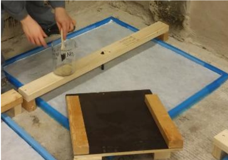
Figur 23. Ympning av mögelsporer på cTrap med pensel.
