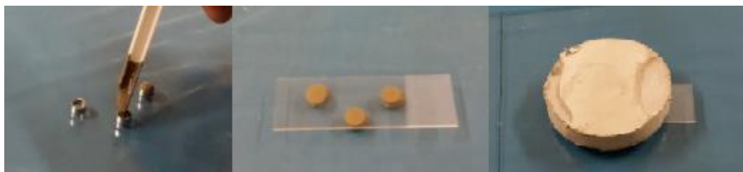
Figur 32. Vänstra bilden visar fyllning av metallringarna. Mittersta bilden visar när avjämningsmassan trycks ner av en liten glasskiva. Bilden till höger visar en tyngd som läggs på glaset för att trycka ner det.
