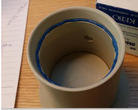
Figur 37. Tätningsband (blått) applicerat på inre avsats i kopp inför montering av prov.
