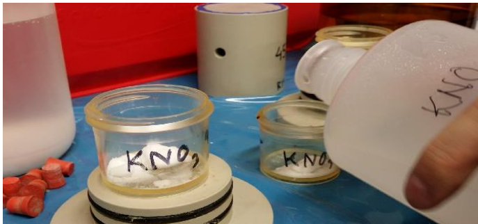
Figur 38. Preparering av koppar med saltlösningar inför koppförsök.
