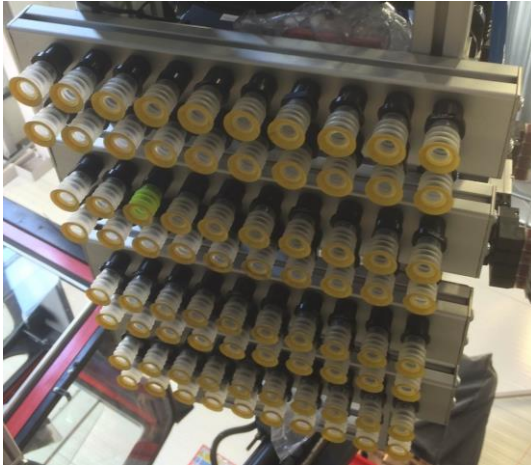
Bild 3: Undersidan av lyftverktyget. Fyra konsoler med 20 sugproppar var.
