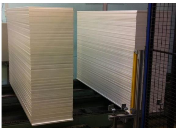
Bild 1: Så här kan skivorna ligga stapplade på varandra innan roboten ska packa ner dem
