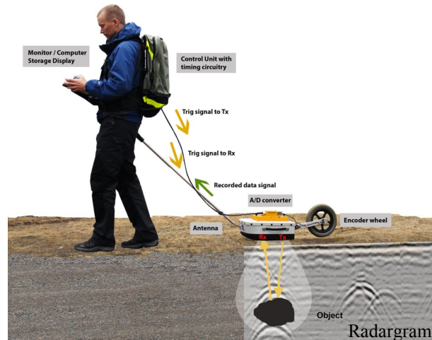
Fig. 9. Principiella tillvägagångssätt för att samla in markradardata. geo-analysis.com, 2016. Återgivet med tillstånd.
