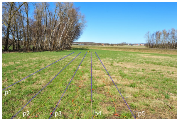
Fig. 1. Lokal 1, Pomonavägen. Fem ERT-profiler är utmärkade, p1 – p5. Dessa är 41 meter långa vardera, och har 1 meter avstånd mellan varandra. Foto och illustration: Anders Plan, 2016.
