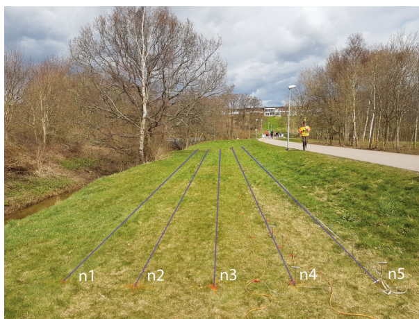
Fig. 2. Lokal 2, Nyhemsleden. Fem ERT-profiler är utmärkade, n1 – n5. Dessa är 41 meter långa vardera, och har 1 meter avstånd mellan varandra. Foto och illustration: Anders
