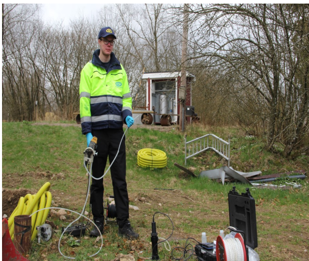
Fig. 10. Peristaltisk pump driven av en bormaskin. Foto: Göran Persson.
