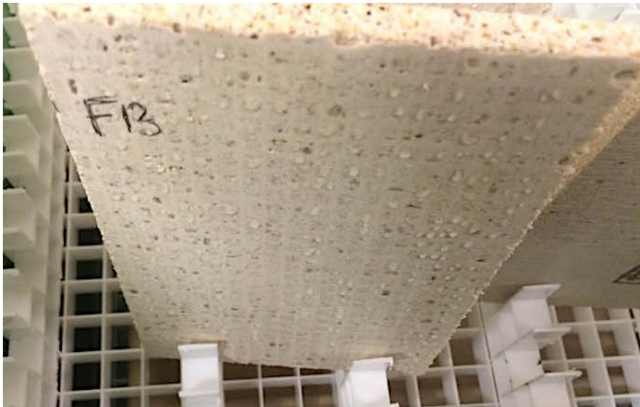
Bild 5.2. Ett gråtande prov från skiva F efter fem dygn i 100% RF.
