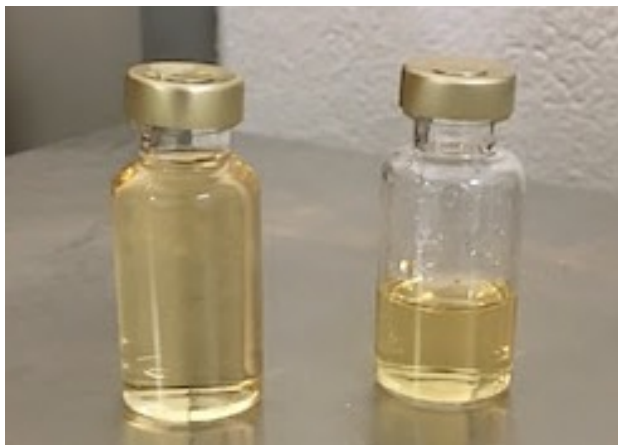
Bild 5.3. Vätska som droppat från skiva F i RF 100% (ampullen till vänster) och RF 94% (ampullen till höger).
