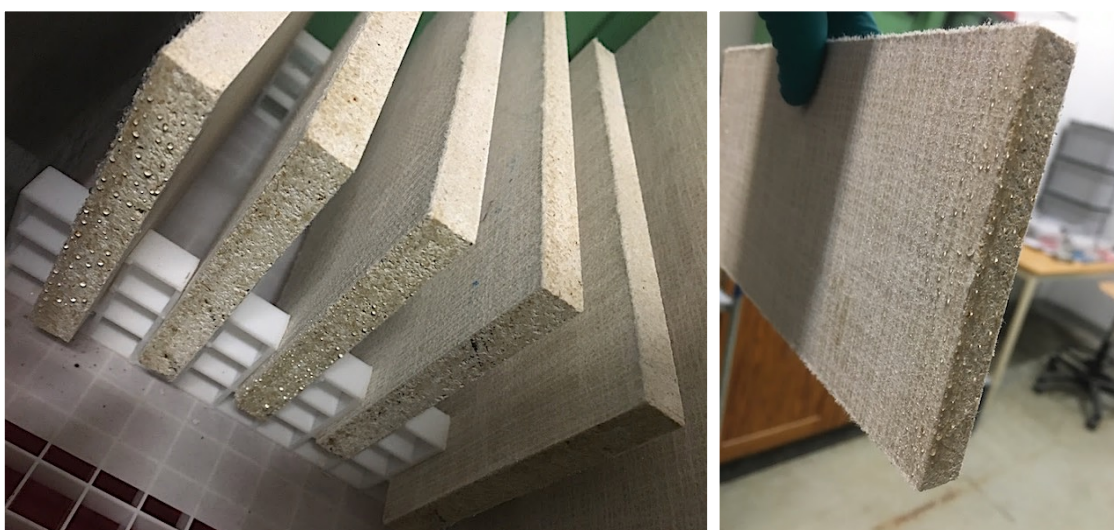
Bild 5.1. Prover från skiva C som exponerats för 100% RF i ca ett dygn.
