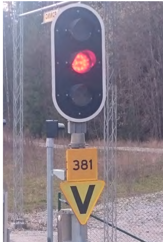
Figur 14 Provsignal monterad på befintlig stolpe (Foto Andreas Mårtensson)
