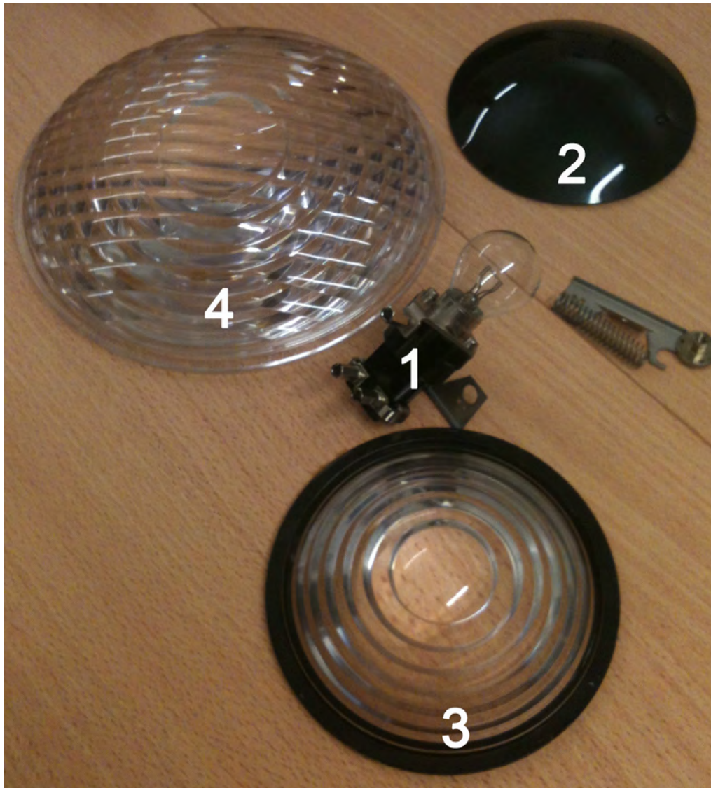
Figur 9 Komponenter huvudljussignal 1. Glödlampa med fäste 2. Färglins 3. Innerlins 4. Ytterlins (Foto: Andreas Mårtensson)
