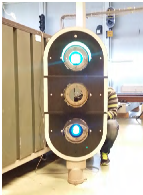
Figur 12 Huvudljussignal i testanläggning Ängelholm (Foto Annamaria Szekelyi)
