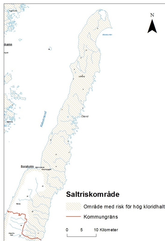
Figur 7: Översiktlig karta för områden med risk för salt grundvatten i Borgholm kommun. Karta modifierad efter kartlager Regional hydrogeologisk information som baseras på information från Beskrivning och bilagor till hydrogeologiska kartan över Kalmar Län serie Ah nr 1.
