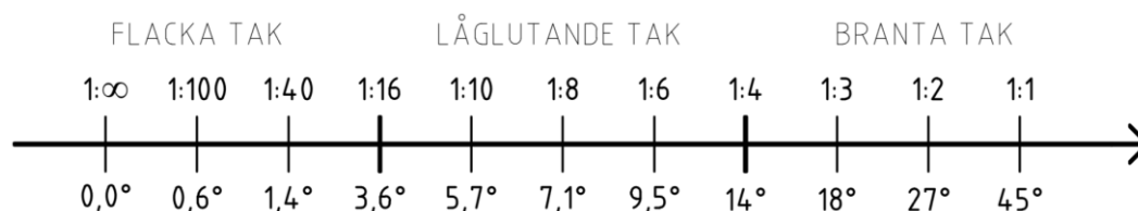
Figur 3.2. Vanliga lutningsförhållanden och motsvarande taklutning.
