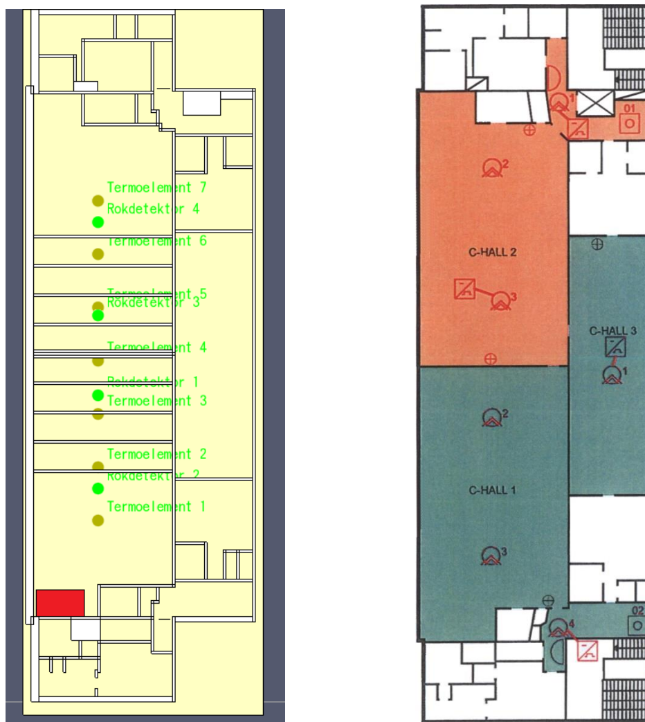
Figur 34. Geometri uppbyggt i FDS över C-hallarna med termoelement samt rökdetektorer (vänster) och planritning från brandskyddsdocumentation över C-hallarna med rökdetektorer (höger).
