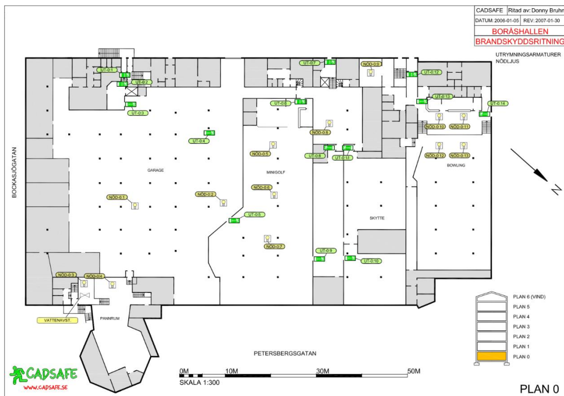
Figur 56. Utrymningsskyltar och nödljus för plan 0.
