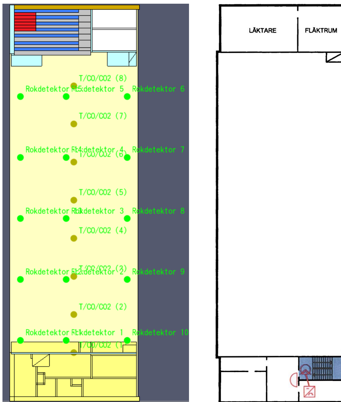
Figur 30. Geometri uppbyggt i FDS över B-hallen med termoelement samt rökdetektorer (vänster) och planritning över B-hallen med rökdetektorer (höger).
