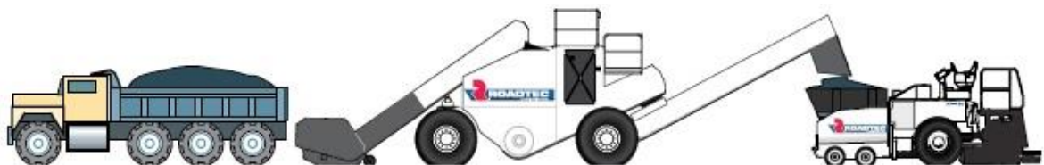
Figur 1, Illustration av Shuttle buggys funktion (Roadtec, u.d.)
