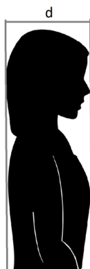
Figur 3.12. Bilden visar vilket mått som beskriver kroppstjockleken, d , och som användes för att bestämma hur lång urgröpnigen i abduktionsortosen borde vara.
