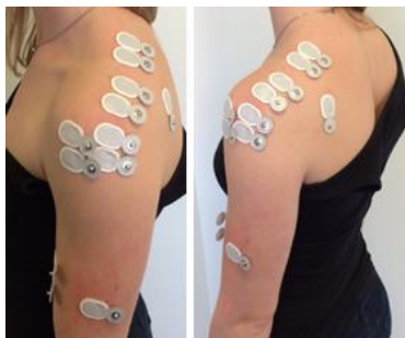
Figur 3.13. Bilden visar elektrodenas placering på trapezius, deltoideus medius, deltoideus anterior och biceps brachii. På varje muskel sitter två elektroder som mäter aktiviteten och en referenselektrod.
