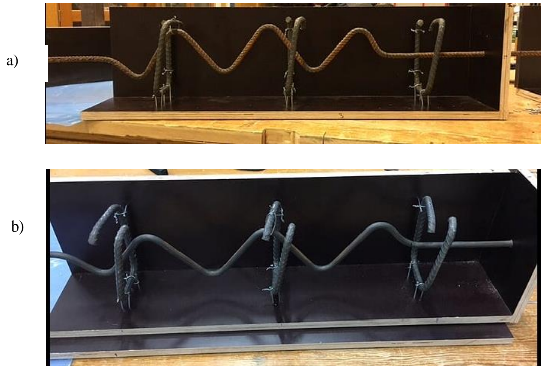
Figur A. 1- Provkropparna innan gjutning, a) ø 8 kamstång b) ø8 S355J2.
