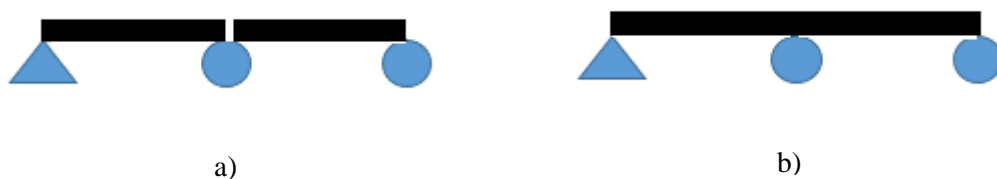
Figur 2.1- a) visar två fritt upplagda balkar på tre stöd. b) visar en kontinuerlig balk på tre stöd.
