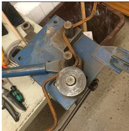
Figur A. 2- Böckning av armeringsjärn.
