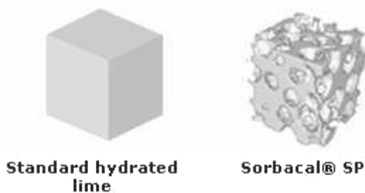
Figur 2. Illustration av skillnaden mellan vanlig släckt kalk - standard hydrated lime - och den ytförstorade släckta kalken Sorbacal. (Sorbacal)
