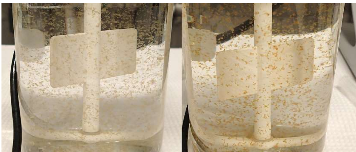
Figur 9. Exempel på hur flockarna såg ut som bäst under flockulatorförsöken. Till vänster: Dosering PAX 31,5 \text{ ml/m}^3 och polymer 2600 \text{ ml/m}^3 . Till höger: Dosering PIX 25 \text{ ml/m}^3 och polymer 2500 \text{ ml/m}^3 . Bägarnas diameter är cirka 9,5 \text{ cm} .
