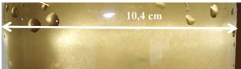
Figur 12. Exempel på hur flockarna i FF3 såg ut som bäst vid fullskaleförsök. PIX 32 ml/m 3 och polymer 2500 ml/m 3 .
