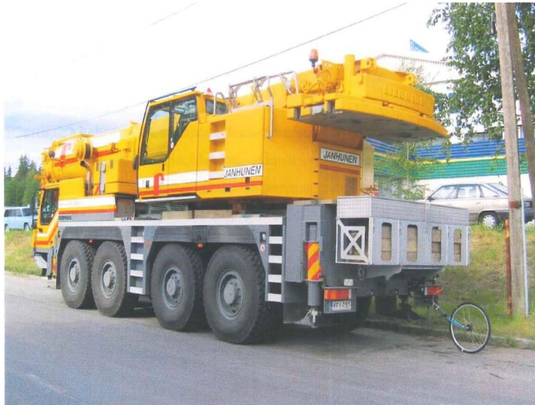
Kuva 3.1 Koekuormittava ajoneuvo, johon on kiinnitetty nopeuden mittalaite
