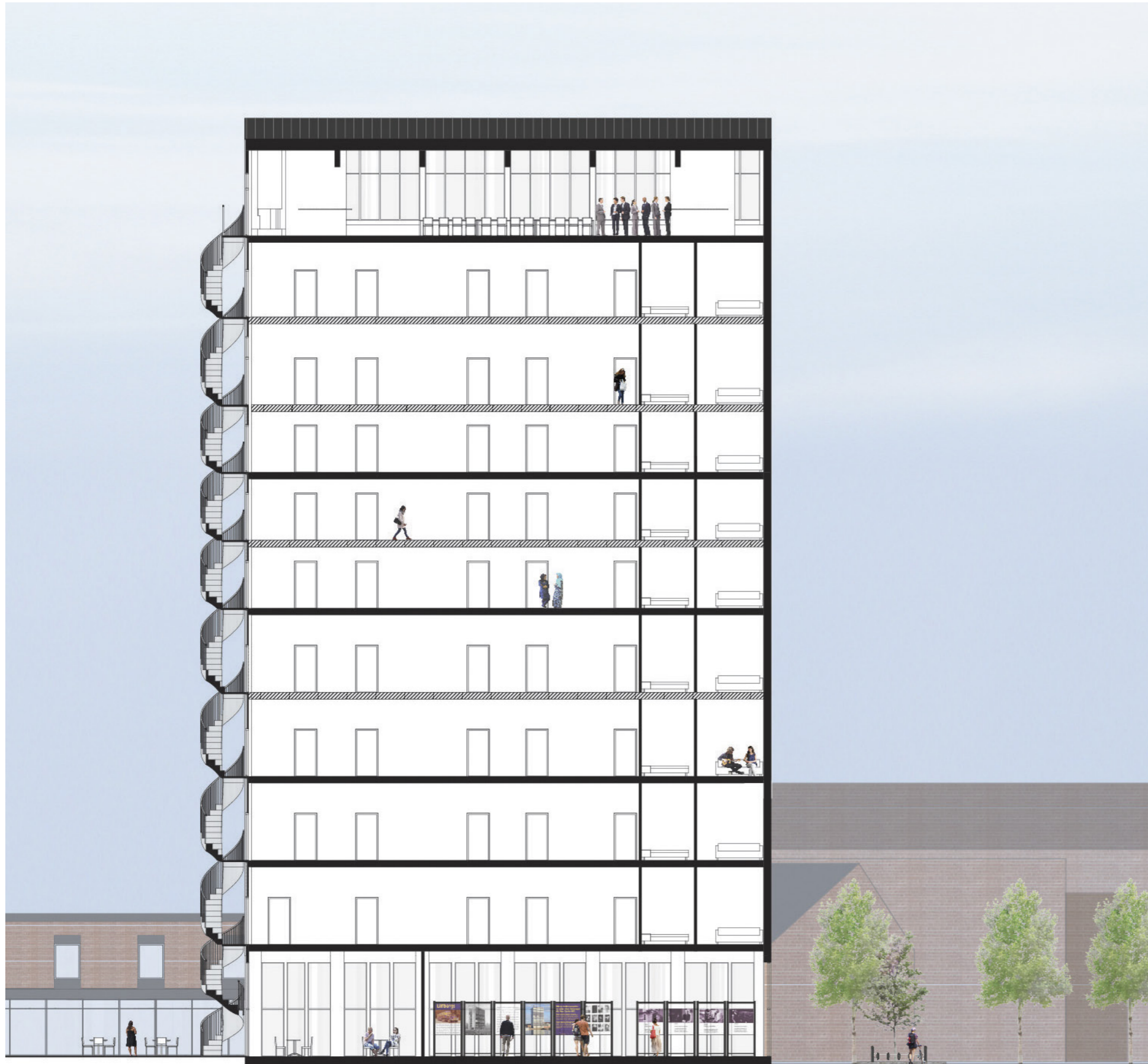
Sektion A. Skala 1:200. Här syns de fyra nya bjälklagen (de skrafferade) som lagts till i byggnaden
