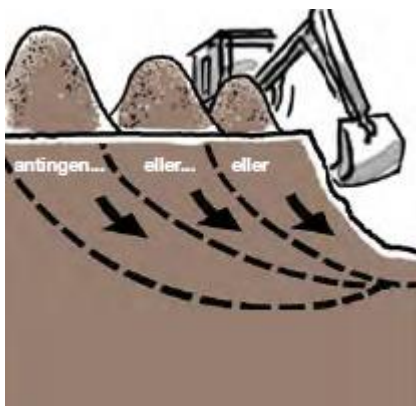
Figur 8: Illustrativ bild på hur massor inte bör placeras (Lundström et al, 2015)
