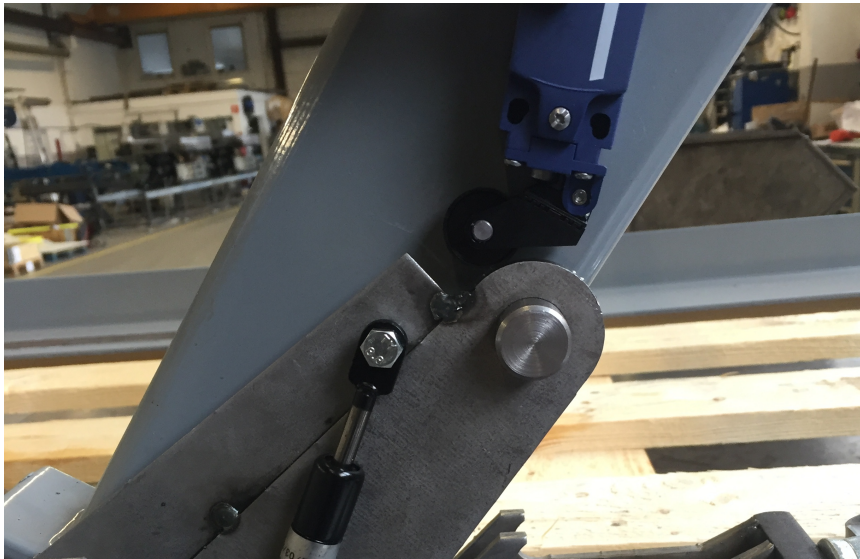
Figur 8.2, övre gränsläge monterat till saxarmen för att känna av när sprintarmar är uppfällda.
