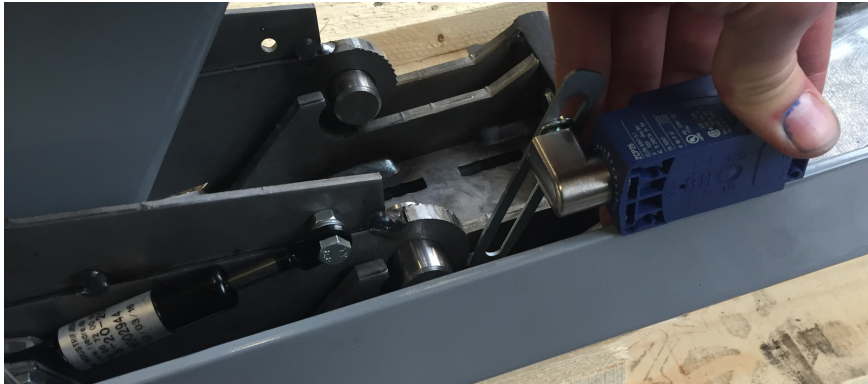
Figur 8.1, mellangränsläge monterats till bottenramen för att känna av aktiveringsläget
