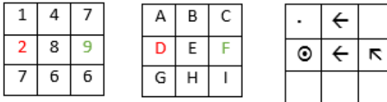
Figur 5.14. Skattad flödesväg mellan startcell D och målcell F. Resultat från tillämpningen av A*-sökalgorithm enligt tabell 2.
