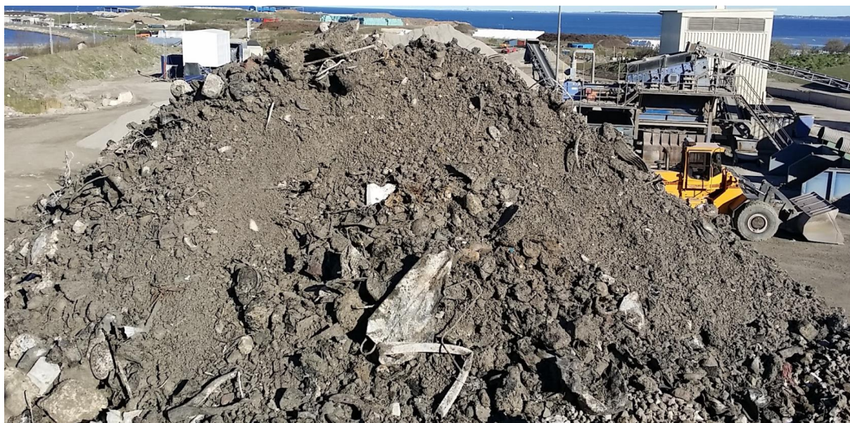
Figur 12. Färskt slagg direkt från förbränning.
