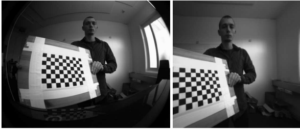
Figur 3. Man kan kalibrera en kamera så att raka linjer i verkligheten blir raka på bilden
