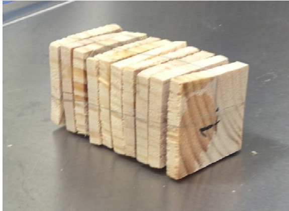
Figur 12. Ett prov med 10 stora träbitar och 5 små som hölls ihop med ståltråd.
