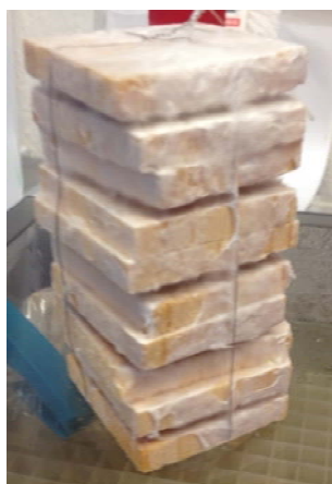
Figur 13. Träprov med 50 % fuktkvot som hade mycket mycel på utsidan.
