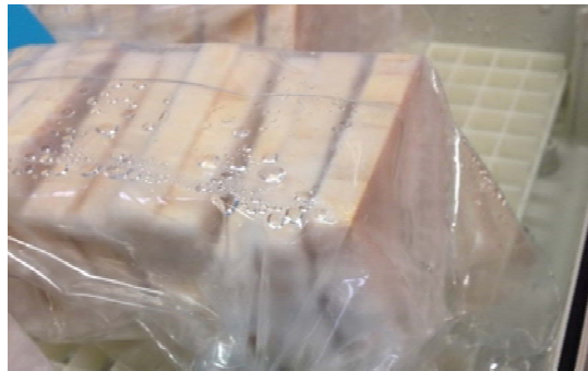
Figur 22. Kondens hade bildats på insidan av plasten på prover med höga fuktkvoter.
