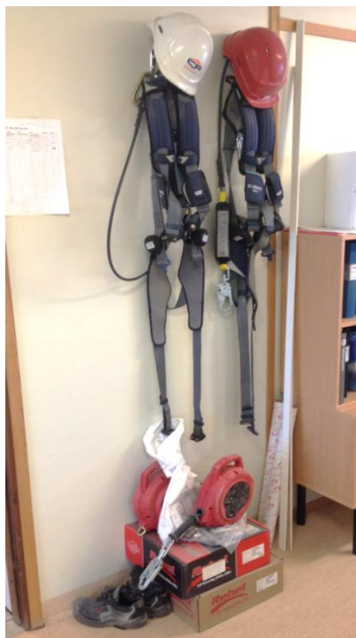
Figur 7: Personlig fallskyddsutrustning, fallsele och stoppblock
