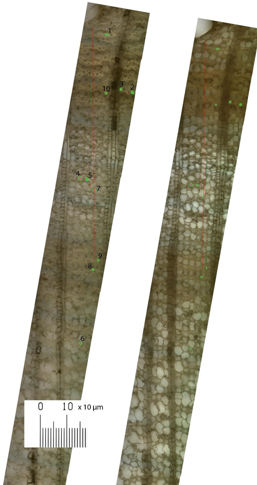
Bilder av abachi ( Triplochiton scleroxylon ) \times 400 förstoring, vattenmättat t.v. och torrt t.h.
