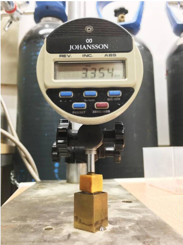
Figur 12. Ett träprov mäts i radiell riktning i en mätklocka.
