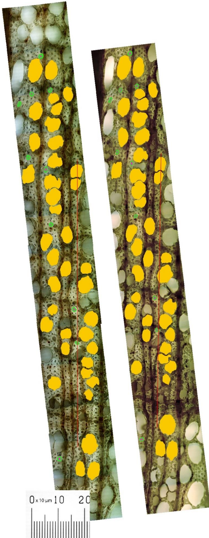
Bilder av bok ( Fagus sylvatica ) \times 400 förstoring, vattenmättat t.v. och torrt t.h.
