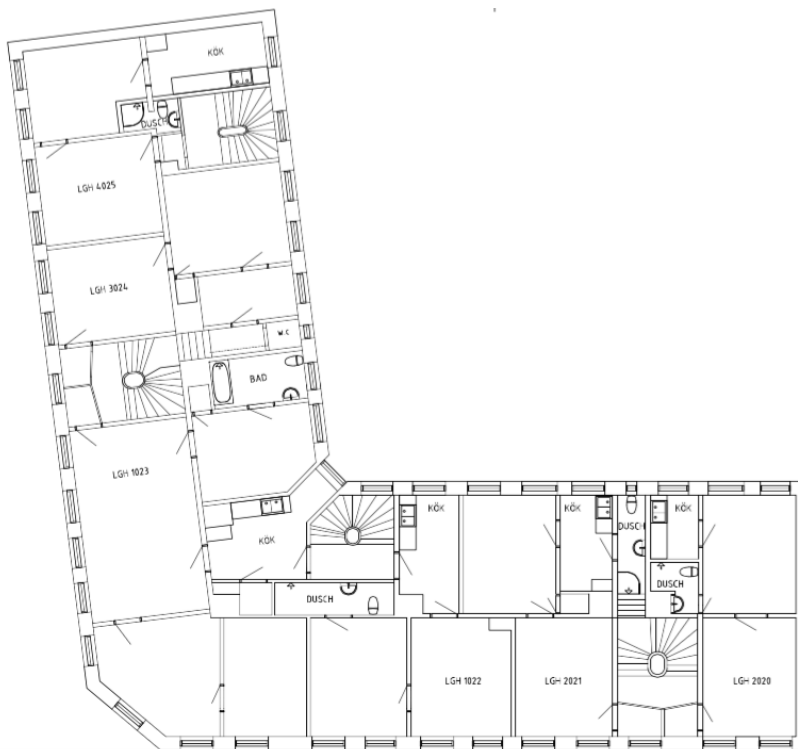
Figur 5-8: Planritning för plan 3. Ritningen visar var bärande tvärgående väggar finns.
