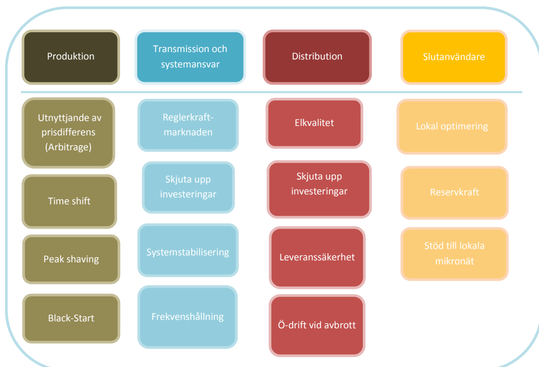
Figur 4. Energilagringens systemnytta uppdelat kolumnvis för energisystemets olika nivåer. Det är värt att notera, att slutanvändare också kan vara elproducent (Widegren, 2016).
