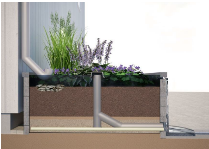
Figur 3.6 Skiss över uppbyggnaden av regnbädd typ 5 (Lindfors, et al., 2014).
