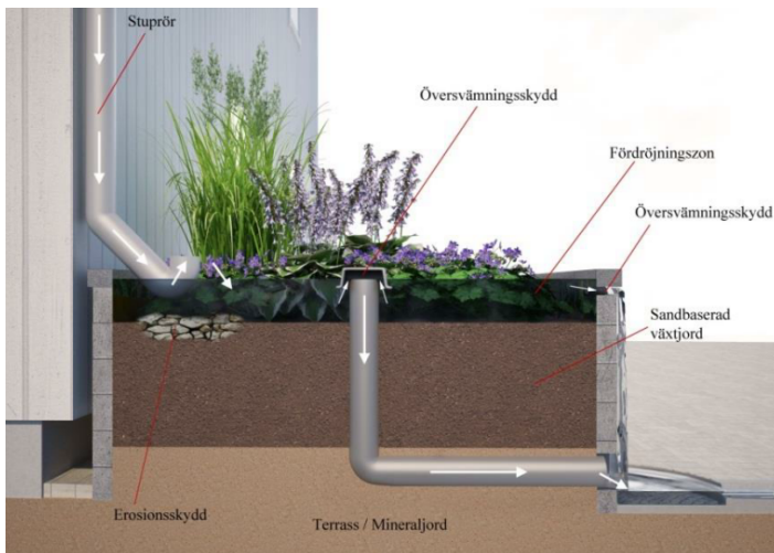
Figur 3.3 Skiss över uppbyggnaden av regnbädd typ 1 (Lindfors, et al., 2014).
