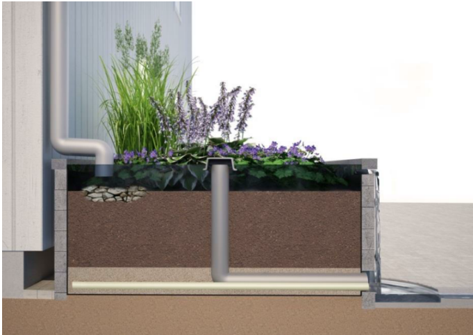
Figur 3.5 Skiss över uppbyggnaden av regnbädd typ 4 (Lindfors, et al., 2014).
