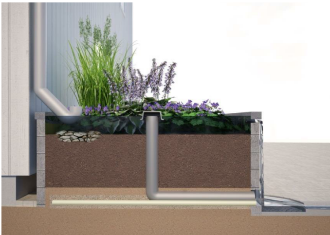
Figur 3.4 Skiss över uppbyggnaden av regnbädd typ 2 (Lindfors, et al., 2014).
