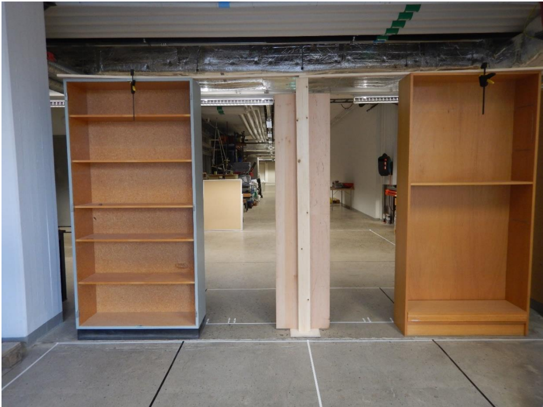
Figur 5.3 Försöksupställning för scenario med två 0,60 m öppningar med 0,50 m avstånd emellan.
