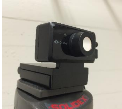
Figur 6. Sensor för registrering av huvudrörelser.
