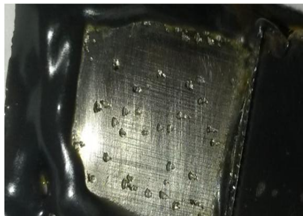
Figur 1 Yta av rostfritt stål som är kraftigt utsatt för gropfrättningskorrosion. Ytan på bilden är ca 1 cm 2 .
