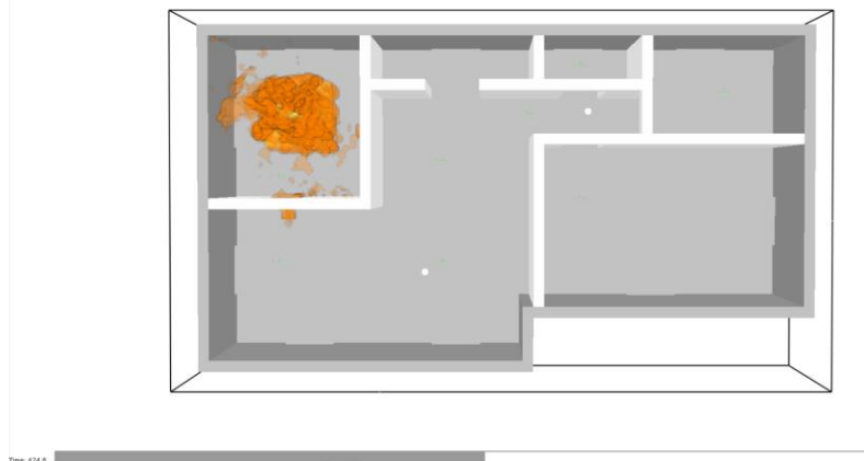
Figur 95 Förbränning sker utanför brandrummet vid ungefär 430 sekunder.
