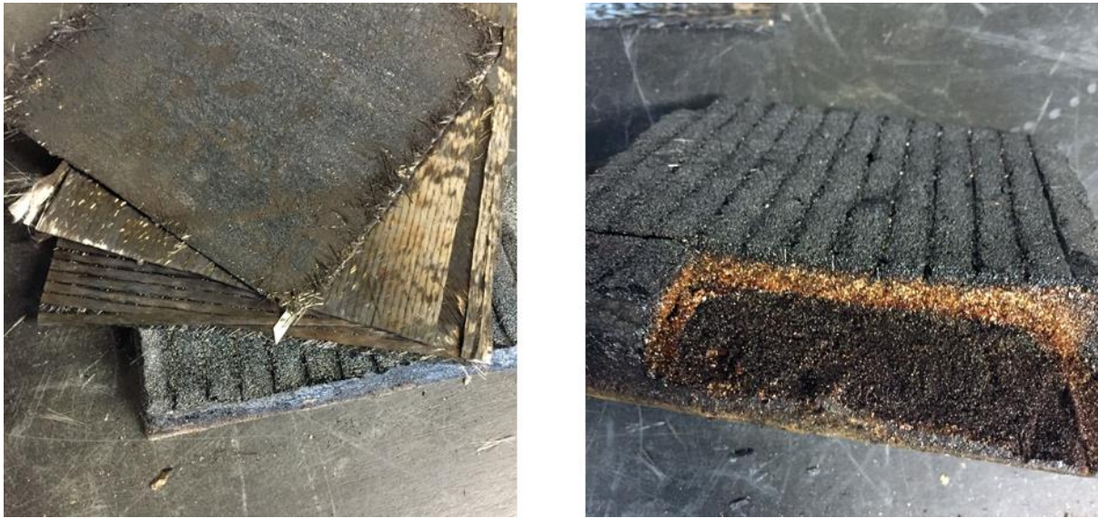
Figur 6.12. På den vänstra bilden syns hur laminatet släppt från kärnan och de olika skikten i laminatet fallit isär. På den högra bilden syns förkolning av Divinycell-kärnan.
