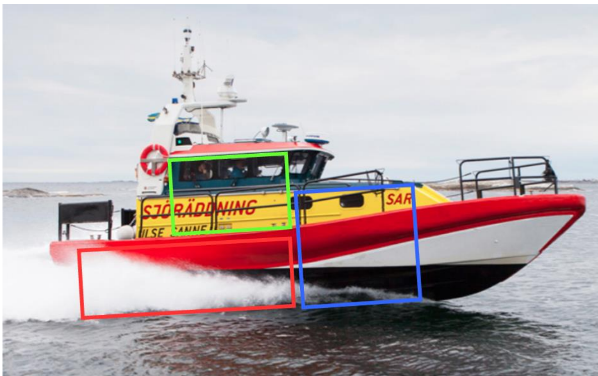
Figur 2.1. Ett fartyg i Victoriaklassen med de tre större utrymmena markerade. Grönt markerar styrhytten, blått markerar transportutrymmet och rött markerar maskinrummets placering. Bild tagen från SSRS grafiska guidelines.
