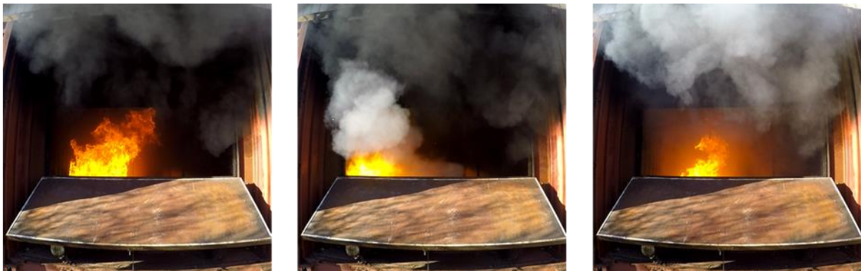
Figur 6.4. Bilder tagna före, under och efter aktivering av PGA-granaten i försök 3. Bilden till vänster är tagen tio sekunder innan aktivering, bilden i mitten under aktivering och den högra tio sekunder efter aktivering.
