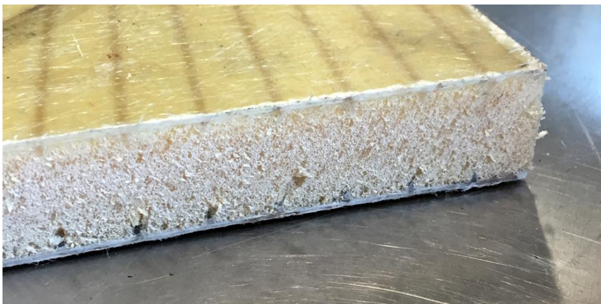
Figur 2.4. Sandwichkomposit bestående av en Divinycell-kärna med glasfiberlaminat på vardera sidan.
