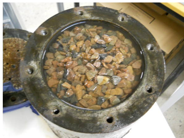
Figur 18 - Behållare fylld med grus, vatten och provkropp
