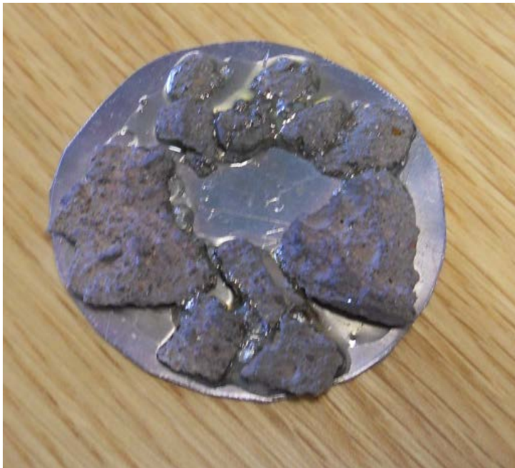
Figur 23 – Uthuggna bitar fastlimmade på en metallplatta. De större bitarna är från en urlakad provkropp
