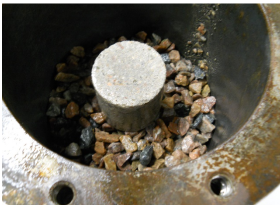
Figur 17 - Behållare med några centimeter grus och provkropp
