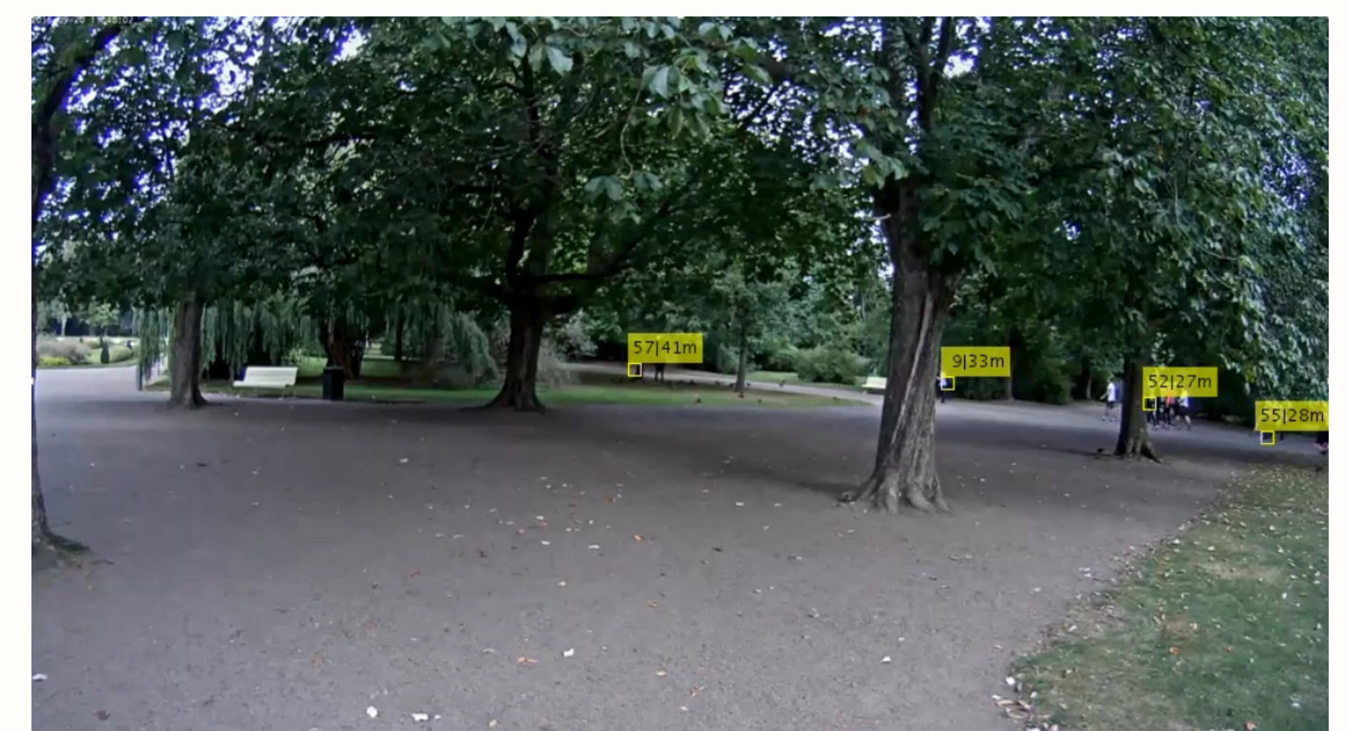
Figure 1: Visualisering av tracking. Vänstra siffran är id och högra siffran är avstånd från sensorn i meter.
