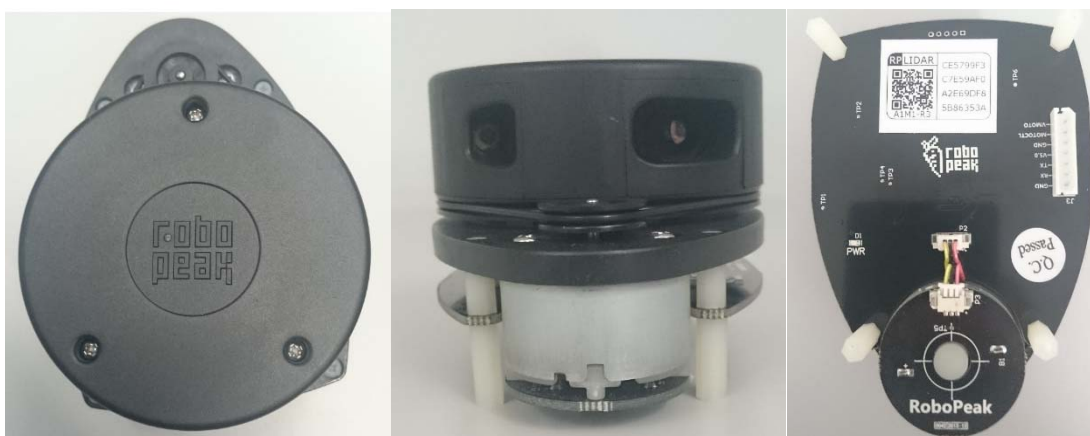
Figur 4. Laserskannern RPLIDAR sedd ovanifrån, framifrån och underifrån. Lasersändare samt mottagare kan ses i bilden till i mitten.
