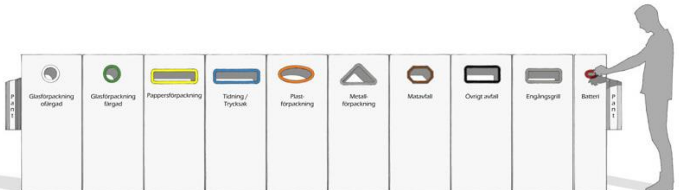
Figur 2.3l. Figuren visar de rekommendationer för utformning av inkasthål © Håll Sverige rent. 2016.
