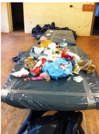
Figur 3.3g. Sorteringsbord med avfall vid utförd plockanalys. 2016-09-13 © Ida Björling
