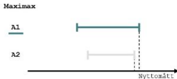
Figur 2.7: Grafisk beskrivning av hur beslut tas utefter maximax-regeln. Vid jämförelse utefter maximax-regeln jämförs de övre intervallgränserna och alternativet med högst värde väljs, i exemplet alternativ ett.
