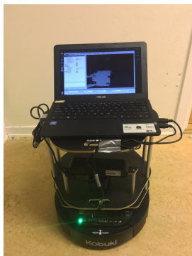
Figur 1: Robotprototypen med namnet Turtlebot där reglermetoden implementerades.
