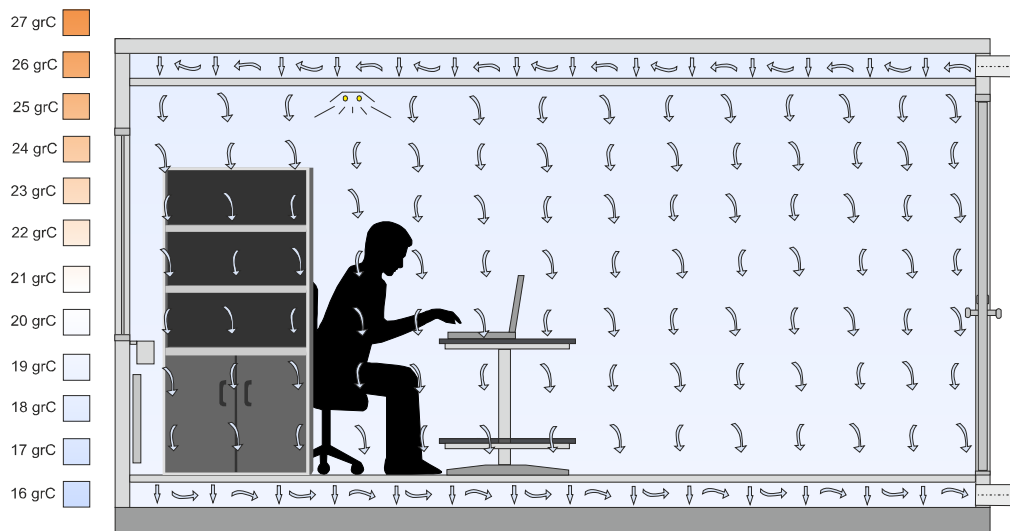
Figur 4: Principskiss luftströmning i kontor med envägsströmning
