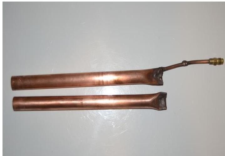
Bild 7.1 Två kopparrör efter lödning
