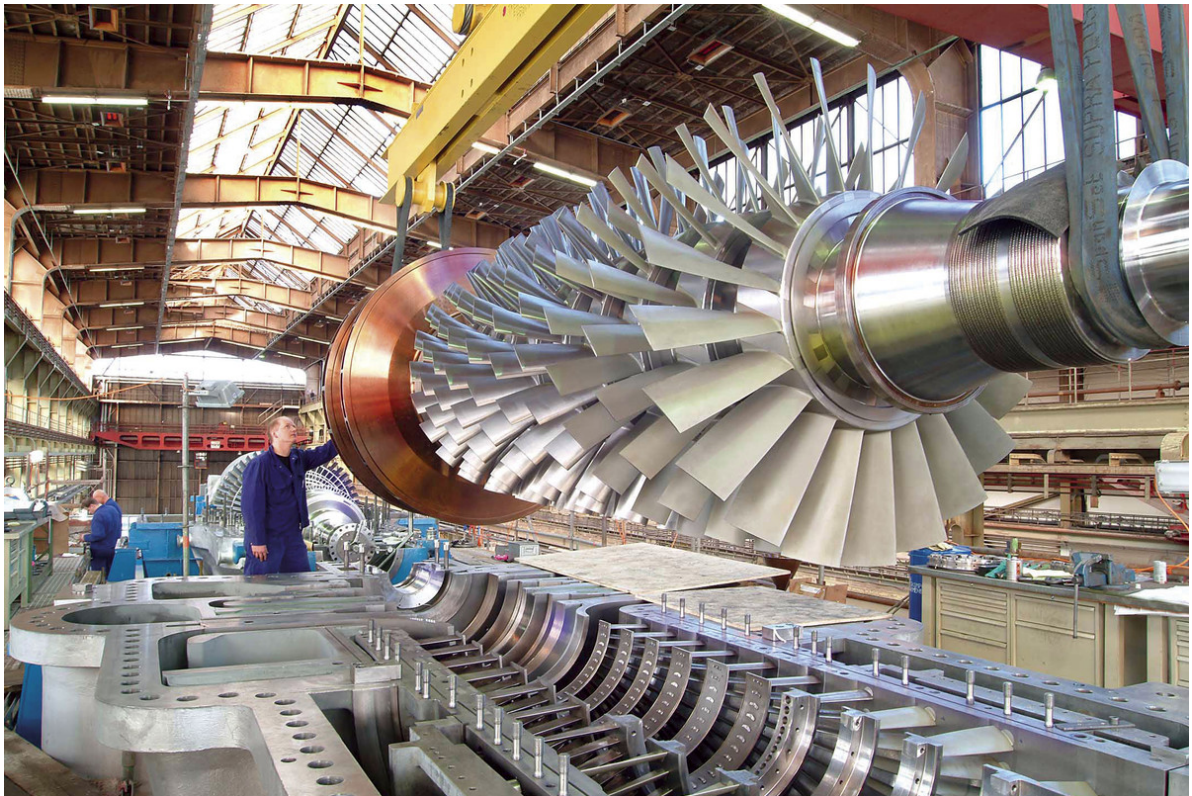
Illustration 4: Lågtryckskompressorerna i Huntorfanläggningen. Notera de två radiella kompressorstegen längst bort. (Bine Informationsdienst 2007)
