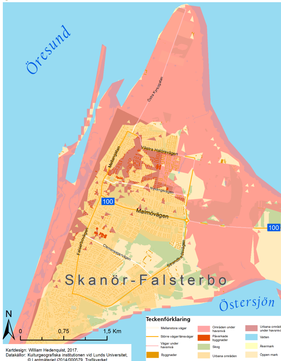
Figur 3: Skanör-Falsterbo och dess översvämmade områden vid en meters havsnivåhöjning utan skydd
